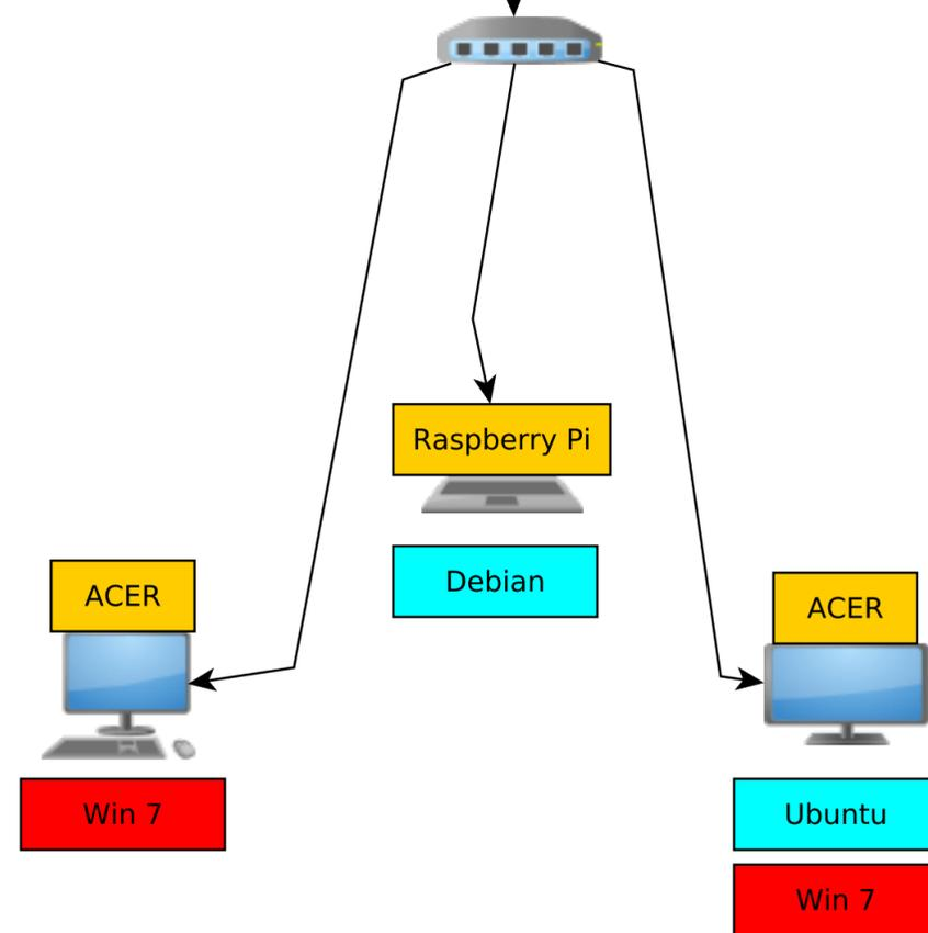
Extender connecté en wifi sur le routeur empêche la résolution DNS de Windows Seven
